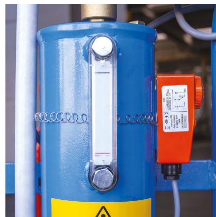
Indicatore del livello dell'acqua e termostato di sicurezza. Water level indicator and safety thermostat.
